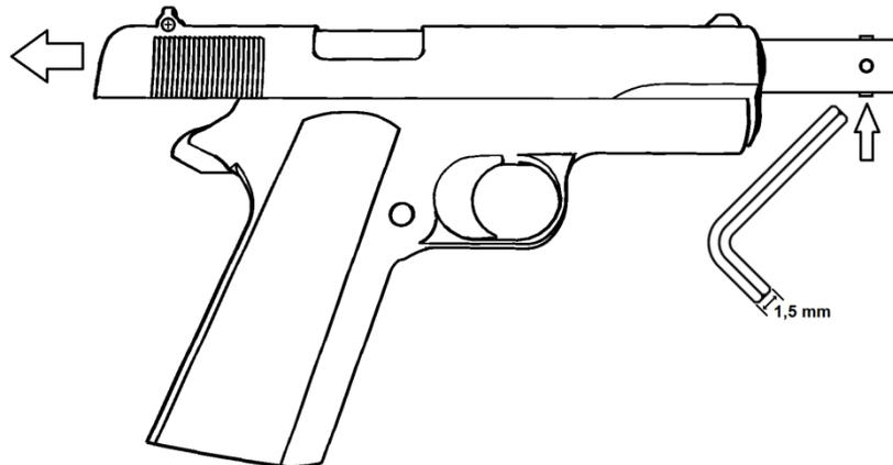
Um den Laser z. B. etwas nach links zu bewegen, muss zuerst die rechte Schraube etwas herausgedreht werden und anschließend die linke etwas weiter hinein. Hierbei muss darauf geachtet werden, dass keine der beiden Schrauben ganz heraus- oder hineingedreht wird. Bei einer Justage in eine andere Richtung wird analog verfahren.
